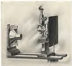
Fig. 32. Projektionsanordnung mit senkrecht stehendem Mikroskop.
